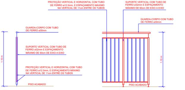
GUARDA-CORPO EM CORTE (ARQUIBANCADA) ESCALA: 1/25
