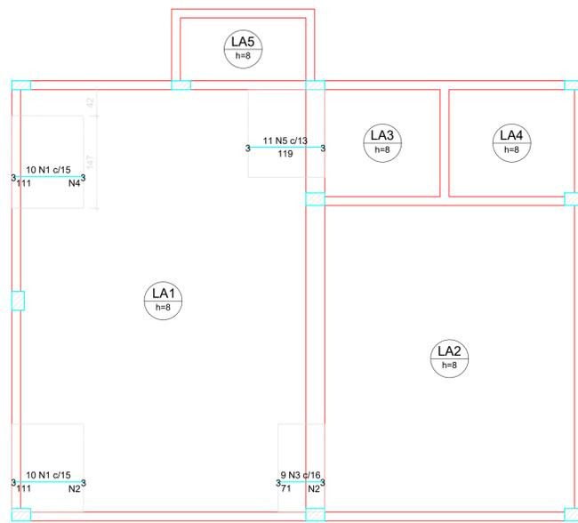
Armação negativa das lajes do pavimento Baldrames (Eixo X)
