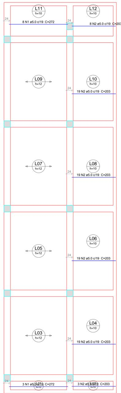
Armação positiva das lajes do pavimento térreo (Eixo X)
